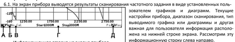
6.2. На рисунке в левом нижнем углу экрана размещен индикатор (A) состояния встроенного аккумулятора, который в зависимости от состояния аккумулятора может быть выведен как:
